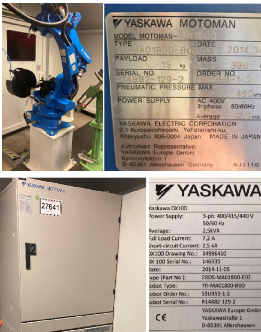
Figura 4 – Robô MA1800 com Fonte de Solda SKS e Controlador DX100
